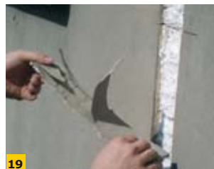
FOT. 14–20. Przykładowe czynności umożliwiające wykonanie oceny stanu istniejącego ocieplenia; fot.: archiwum autora
