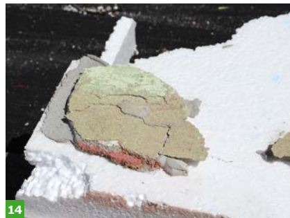
FOT. 13–14. Termoizolację przyklejono do starego, niestabilnego tynku; fot.: autor
