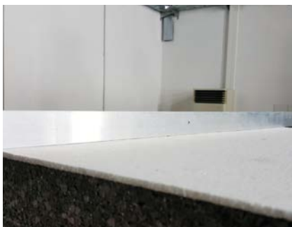
FOT. 6. Kontrola powierzchni styropianu biały-graf za pomocą łąty metalowej – brak widocznych odształceń; fot.: autor
