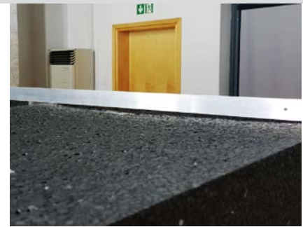
FOT. 4. Kontrola odształceń w płycie graf po zakończeniu naświetlania płyty. Łąta metalowa przyłożona w poprzek do badanej płyty (widoczne prześwity pod łątą); fot.: autor
