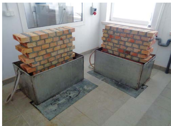
FOT. 1. Mury badawcze przygotowane do iniekcji w metodzie ITB; fot.: autor
