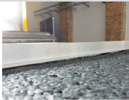
FOT. 3. Odształcenia płyty graf wskutek naświetlania za pomocą sztucznego słońca. Kontrola powierzchni za pomocą łąty metalowej (widoczne prześwity pod łątą); fot.: autor
