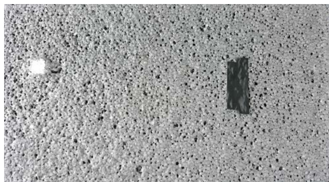
FOT. 1. Uszkodzenia widoczne na powierzchni płyty graf (ubytki granulek styropianowych wskutek przekroczenia temperatury mięknięcia styropianu) – powierzchnia uzyskana po zakończeniu naświetlania płyty; fot.: autor
