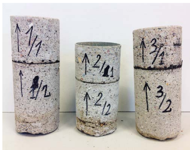
FOT. Widok pobranych rdzeni (przykład – hala nr 2); fot.: T. Majewski
