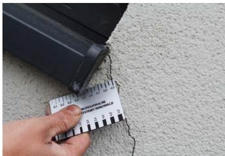
FOT. 3. Szerokość rozwarcia rysy; fot.: autor
