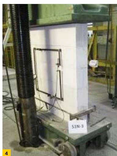
FOT. 4–6. Widok elementów próbnych każdej z serii przed badaniem: model S1N-3 (4), model S1F1-2 (5), model S1F2-1 (6), ; fot.: autorzy
