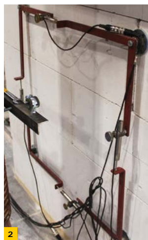
FOT. 2-3. Elementy do pomiaru przemieszczeń: baza do pomiaru przemieszczeń (2), czujnik indukcyjny (3); fot.: autorzy
