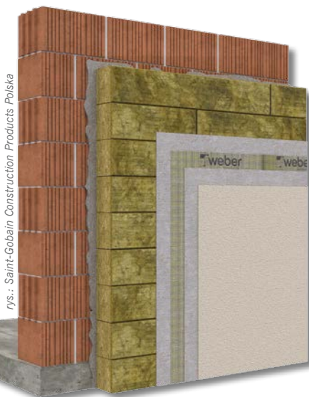
RYS. 2. Schemat systemu ociepleń weber.therm WM z wełną mineralną ISOVER FASOTERM 35
