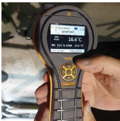
FOT. 3. Kontrola warunków ciepłno-wilgotnościowych (punkt rosy) podczas aplikacji produktów Atlas
