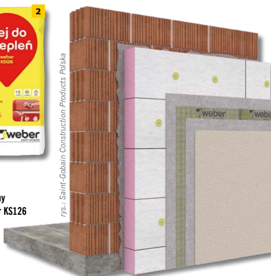
RYS. 3. Schemat systemu ociepleń weber.therm LAMBDA z płytą weber PH930
