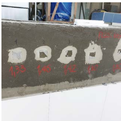
FOT. 2. Badanie pull-off na obiekcie – rzeczywiste uzyskane wartości adhezji szlamu i kleju
