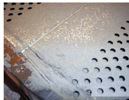
FOT. 5. Próbką po posypaniu pyłem cementowym w ilości 5,0 kg/12 m 2 ; fot.: autorzy
