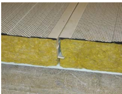
FOT. 3. Fragment lekkiej ściany osłonowej, stanowiący próbkę poddaną badaniom akustycznym; fot.: autorzy
