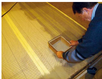
FOT. 4. Realizacja zabrudzenia próbki sitem; fot.: autorzy
