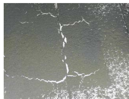
FOT. 9. Zastygła próbka po zabrudzeniu 24,5 kg/12 m 2 i zroszeniu wodą 6 litrów/12 m 2 ; fot.: autorzy
