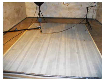
FOT. 11. Widok próbki ułożonej na podłodze komory pogłosowej; fot.: autorzy
