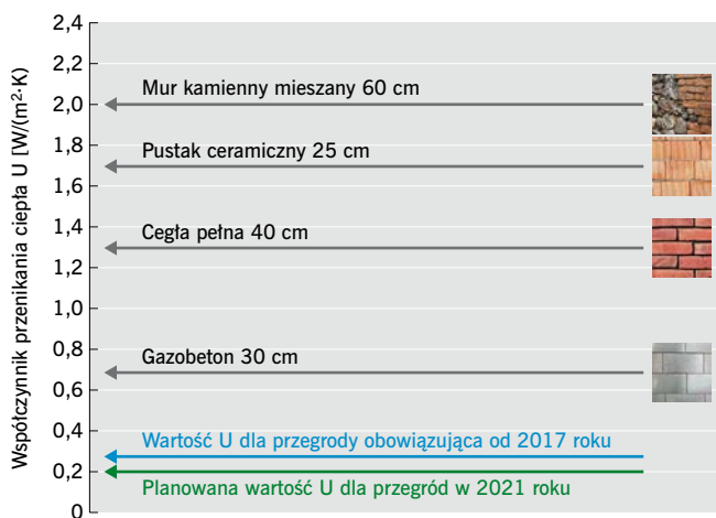
RYS. 3. Współczynnik przenikania ciepła materiału oraz wielkość tego współczynnika U dla całej przegrody wymaganej przez prawo w 2017 i 2021 roku
