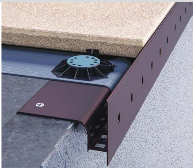
RYS. 6. Detal okapu tarasu naziemnego; rys.: Renoplast
