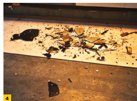
FOT. 1–4. Przebieg badania: początkowy etap badania (1), zaawansowana degradacja okładzin (2), elewacja wentylowana po badaniu (3) oraz widok elementów, które odpadły (4); fot.: ITB
