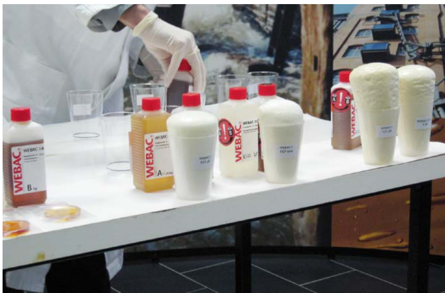
FOT. Próby laboratoryjne ze spienialnymi środkami WEBAC
