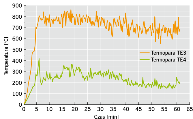
RYS. 3. Wyniki pomiaru temperatur dla termopar TE3 i TE4; rys.: autorzy
