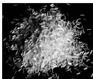
FOT. 9. Włókna szklane cięte długości 6 mm; fot.: [67]
