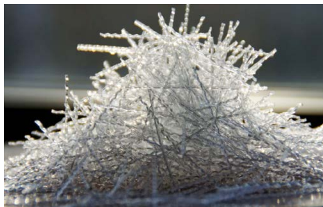
FOT. 1. Makrowłókna polimerowe; fot.: [31]
