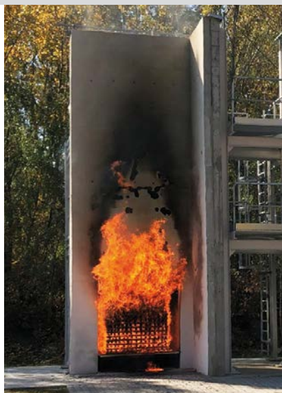
FOT. 2. Ściana EPS podczas badania; fot.: autorzy
