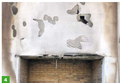
FOT. 2. Ściana EPS podczas badania; fot.: autorzy
