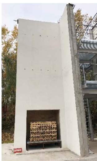
FOT. 1. Widok ściany przygotowanej do badania; fot.: autorzy
