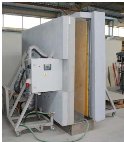
FOT. 2. Widok urządzenia do badania grzania–deszczowania; fot.: [2]
