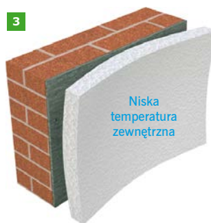
RYS. 2–3. Efekt tzw. miksowania płyt termoizolacyjnych; rys.: [7]
