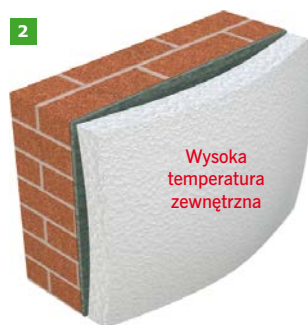
RYS. 2–3. Efekt tzw. miksowania płyt termoizolacyjnych; rys.: [7]
