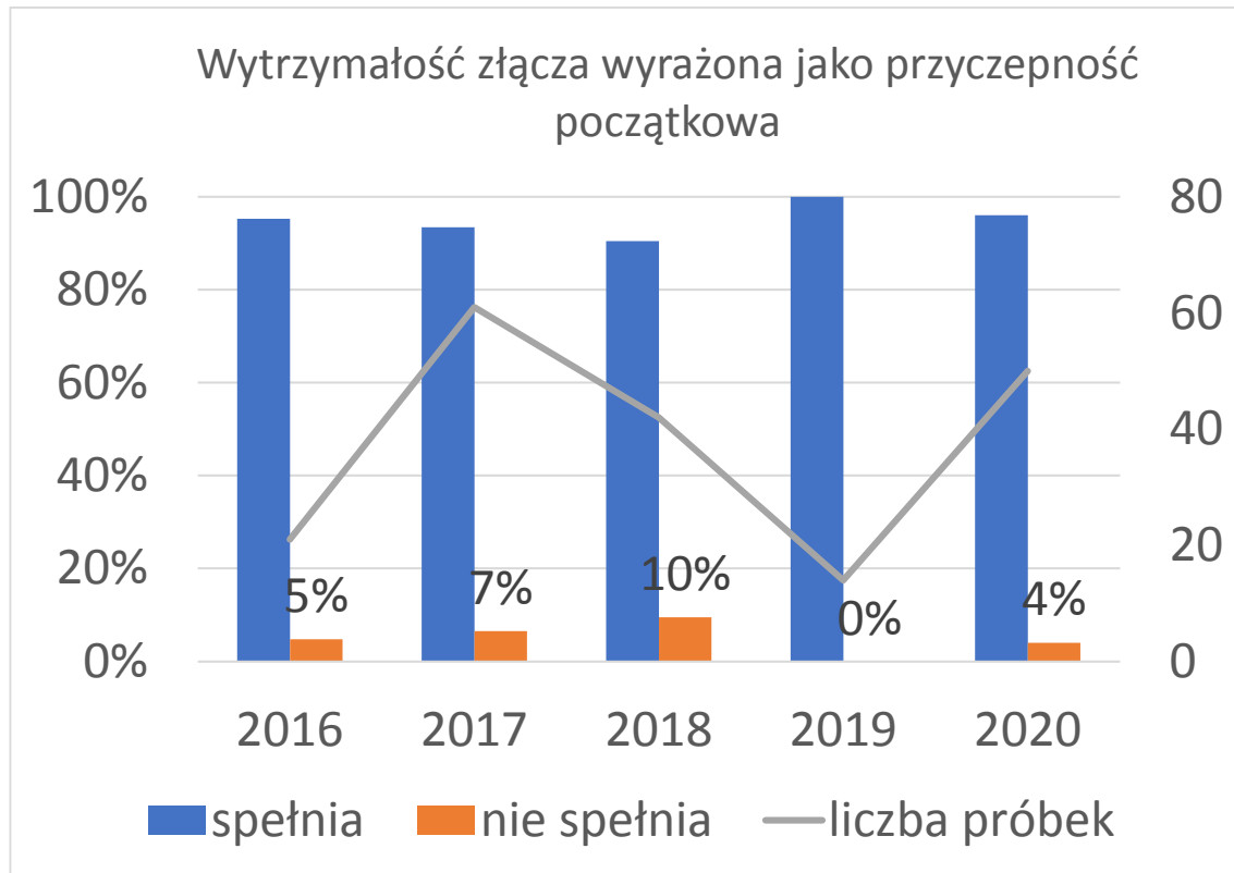
Rysunek 11 Spełnienie wymagania dotyczącego deklarowanej wytrzymałości złącza wyrażona, jako przyczepność początkowa w latach 2016-2020
