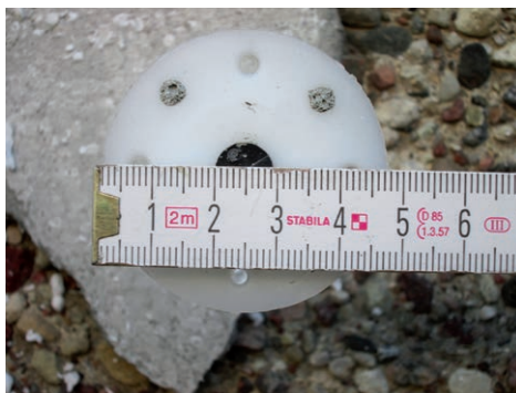
FOT. 10. Pomiar średnicy talerzyka łącznika; fot. archiwum autora
