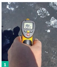
FOT. 1–2. Odczyt temperatury przed (194°F/90°C) oraz po (111°F/43°C) zastosowaniu jasnego pokrycia dachowego; fot.: www.buildingenclosureonline.com
