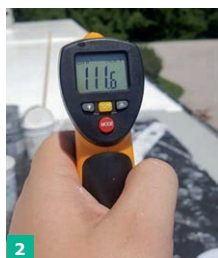
FOT. 1–2. Odczyt temperatury przed (194°F/90°C) oraz po (111°F/43°C) zastosowaniu jasnego pokrycia dachowego; fot.: www.buildingenclosureonline.com
