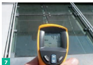
FOT. 4–9. Temperatury nagrzewania się pokryć dachowych (temp. otoczenia 30°C, w cieniu): dachówka w kolorze grafitowym (4), kamień lub beton (5), blacha cynkowa (6), szkło od zewnątrz (7), szkło od wewnątrz (8), stalowa konstrukcja wsporcza pod szkłem (9); fot.: [1]
