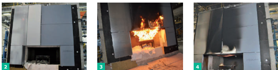
FOT. 2-4. Widok próbki przed badaniem (2), w 121. min badania (3) i po badaniu (4); fot.: archiwum ITB
