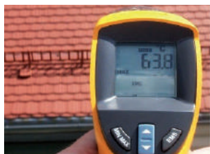
FOT. 10. Temperatura pokrycia dachowego w kolorze czerwonym (ceglastym); fot.: [1]
