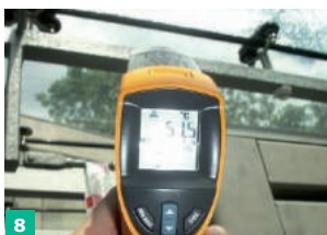
FOT. 4–9. Temperatury nagrzewania się pokryć dachowych (temp. otoczenia 30°C, w cieniu): dachówka w kolorze grafitowym (4), kamień lub beton (5), blacha cynkowa (6), szkło od zewnątrz (7), szkło od wewnątrz (8), stalowa konstrukcja wsporcza pod szkłem (9); fot.: [1]
