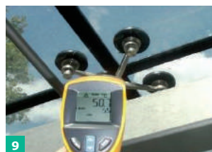
FOT. 4–9. Temperatury nagrzewania się pokryć dachowych (temp. otoczenia 30°C, w cieniu): dachówka w kolorze grafitowym (4), kamień lub beton (5), blacha cynkowa (6), szkło od zewnątrz (7), szkło od wewnątrz (8), stalowa konstrukcja wsporcza pod szkłem (9); fot.: [1]
